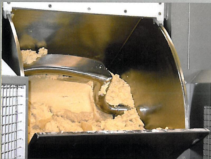
Месильный орган машины, форма которого явилась результатом длительного эксперимента, сделана из единой отливки из нержавеющей стали AISI 304 и затем отполированной.
